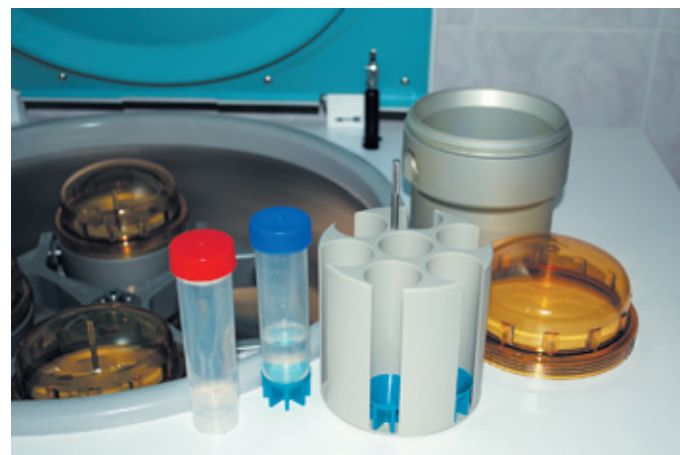
Рис. 7. Центрифуга, бакет-ротор, центрифужный стакан с антиаэрозольной крышкой, вкладыши для пробирок и центрифужные пробирки
